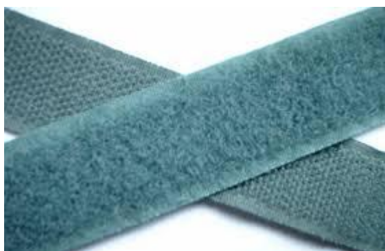
Detalle de las dos superficies que forman el velcro (Garfios y Rizos)
